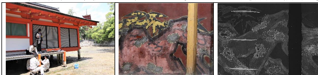
図1:厳島神社での塗装耐侯実験 図2: 陽明門壁画絵画の実像とX線画像の比較調査
